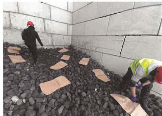
Die Wissenschaftler*innen bereiten derzeit Proben des verwendeten Feuerfestmaterials aus der Stahl- und Zementherstellung vor, um eine Grundlage für die anstehenden Forschungsaktivitäten zu schaffen.
